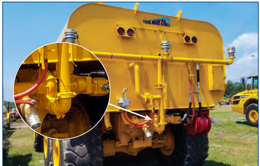
101-B69875 Aquí se muestra la bomba en un sistema de tanque Volvo A40G de 8000 galones. Fabricada por Tidal Wave Tanks, Mulberry, Florida.
